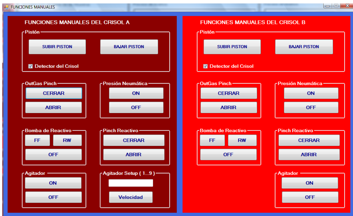
Figura 16. Ventana de control manual de las funciones del analizador, crisol A (izq.) y crisol B (der.)
