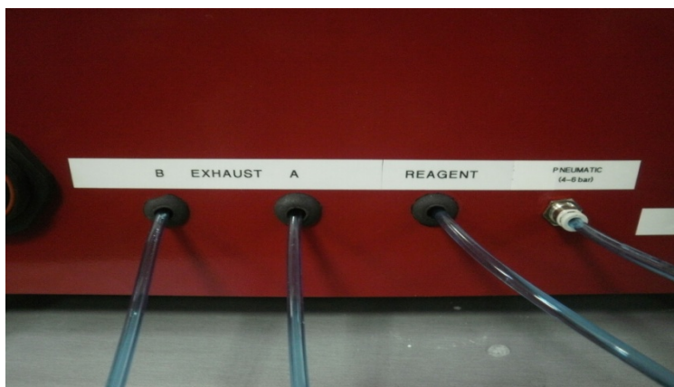
Figura 2. Vista posterior del analizador, donde se observa la entrada de aire comprimido y reactivo, así como la salida de los gases de purga de los crisoles.
