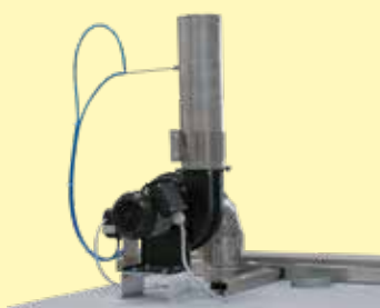
Abertura de entrada de aire y potente soplador de aire de salida montado en el horno
