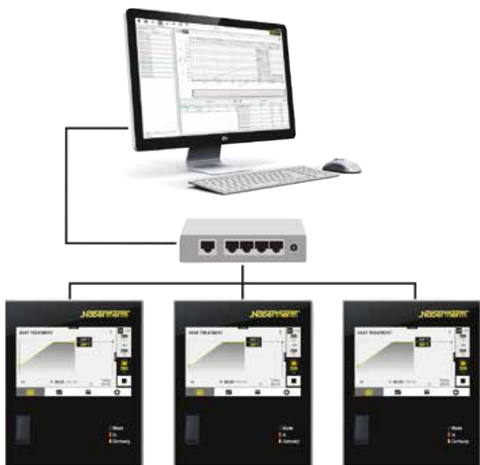
Ejemplo de instalación con 3 hornos
