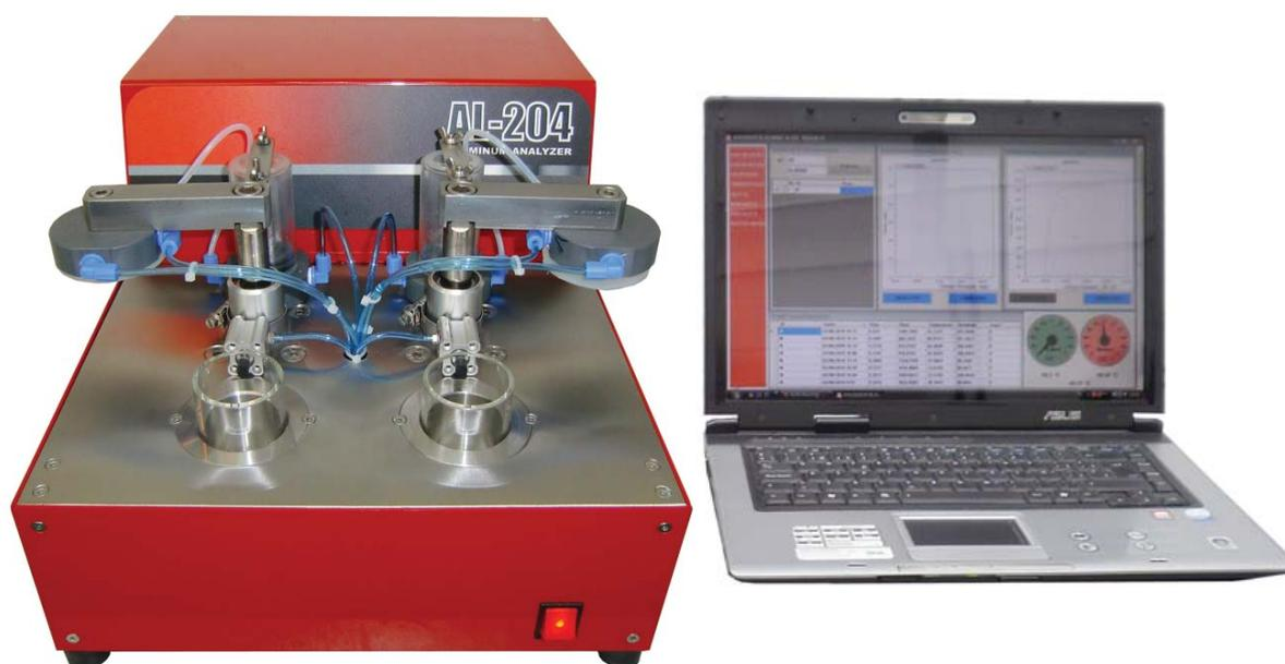
*El equipo AL 204 ha sido especialmente diseñado para la determinación rápida y exacta de la concentración de aluminio en escorias. A través del análisis de los gases resultantes del ataque de la muestra con hidróxido sódico (NaOH) se puede obtener de manera rápida - en tan sólo 10 minutos - y exacta - precisión >99% - el porcentaje de aluminio contenido en la muestra.*
