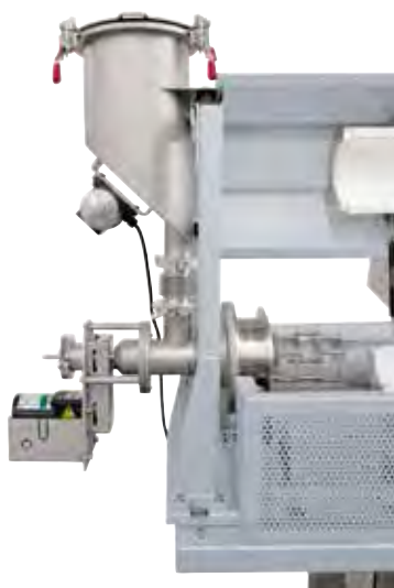
Sistema de vibración en la tolva de llenado para un mejor suministro de polvo
