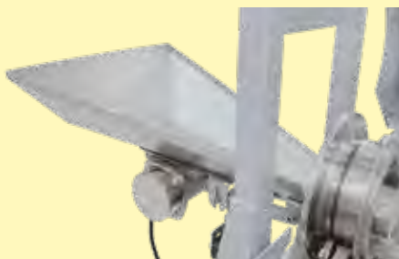
Canal vibratorio en el tubo giratorio para una conveiente alimentación del material
