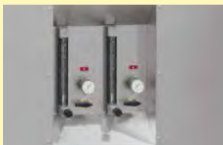
Sistema de inyección de gas automático
