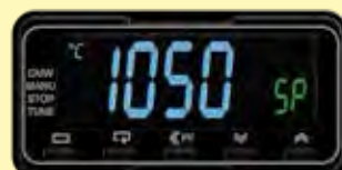
Ejemplo de un limitador de sobre-temperatura
