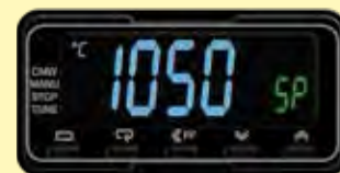
Ejemplo de un limitador de sobre-temperatura
