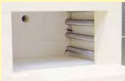
Interior del horno con aislamiento de ladrillos refractarios de alta calidad
