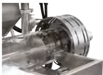
Brida con suplemento de protección contra la radiación térmica (sistema de alimentación de gas 15)
