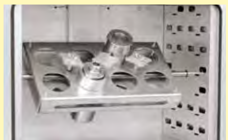
Sistema rotatorio (en este caso con un soporte personalizado para contenedores de autoclave PARR)
