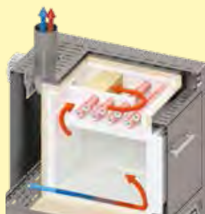
Presentación esquemática de la circulación de aire en el horno de incineración L 24/11 BO
