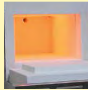
Calentamiento de la mufla por 4 lados
